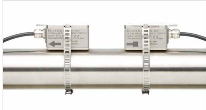
La programación del KATflow 170 es convenientemente llevada a cabo, mediante un lápiz magnético, a través de su pantalla frontal de cristal. Los transductores K1Ex tienen certificación IP 68 como estándar.
